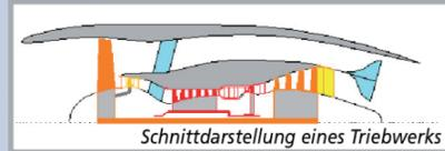
der Turbinen- oder Verdichterschaufeln erfolgt mit einem 2-D-Verfahren. Es wird nicht nur der Wirkungsgrad der Turbinenstufen abgeschätzt, sondern auch der Kühlluftbedarf. Am Ende der Berechnung sind wieder alle charakteristischen Größen der Turbinen wie z.B. der Kanalverlauf bekannt. Ebenso fin-
